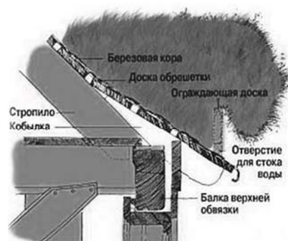
Разрез травяной крыши (зона свеса)
