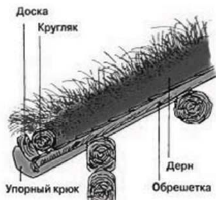
Ограждающий элемент из доски и кругляка
