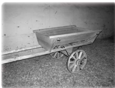
Фото №3 Маневренная одноосная телега. Если сместить кузов немного назад и поставить на петли — можно получить самоскид.
