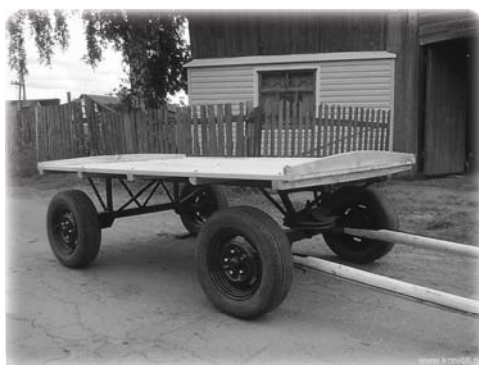
Фото №1 - размер кузова: ширина — 1,2 м, длина — 2 м, высота борта — 0,5 м. По форме и характеристике получается как тракторный прицеп, где задний и боковые борта — открываются. Кузов изготавливается из дерева, по весу лёгкого и прочного, хотя дно нередко сверху дерева покрывают тонким листом железа. Толщина досок достаточно — 30 мм. Передний борт: высота 0,5 м, закрепляется жёстко.
