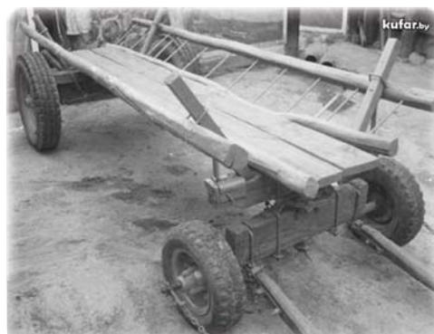
Фото №2 Длина такой телеги может иметь длину до 5-ти метров и рассчитана для перевозки длинных стройматериалов и при наставных решетчатых бортах для перевозки сена.
