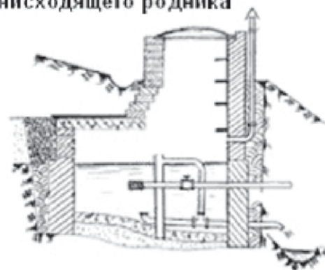
Рис. 6. Устройство каптажа нисходящего родника
