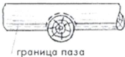
Рис. 4.5. Рубка углов колодца. Разметка паза и вырубка.
